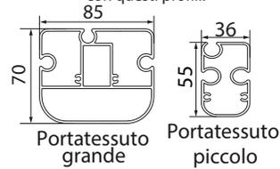
Le S120 plus con interasse delle guide superiore a 400 Cm verranno realizzate con questi profili.
